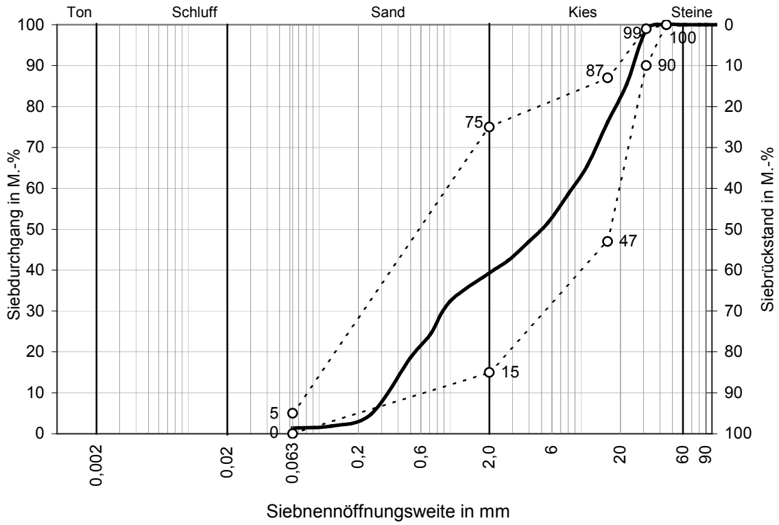
Korngrößenverteilung des Baustoffgemisches 0/32 rd. (FSS)
